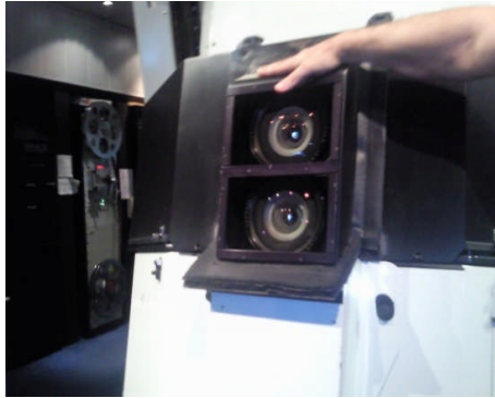
Fig. 3: Objetivos de la cámara a través de los que se proyecta la película. Cada objetivo está diseñado para proyectar, con una angulación determinada, la imagen del ojo derecho y el ojo izquierdo
